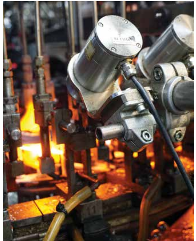
V priebehu celého procesu výroby sa sníma a reguluje teplota, ktorá predstavuje jeden z kľúčových parametrov kvôli použitému materiálu – sklu.
