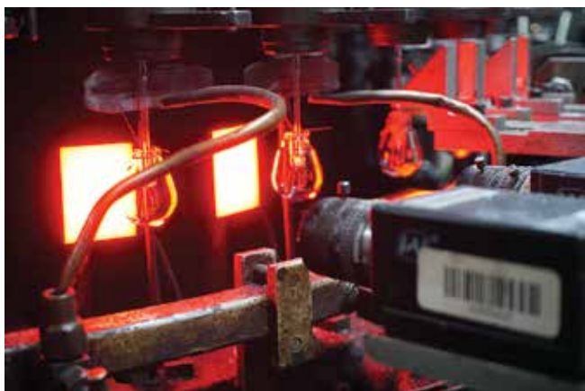
Systémy na snímanie a spracovanie obrazu sú dôležitým prvkom pri zabezpečení bezchybnosti a kvality pri výrobe žiaroviek.
