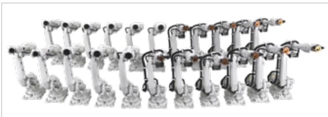
Modulárna platforma priemyselných robotov ABB z modelového radu IRB 67x0
