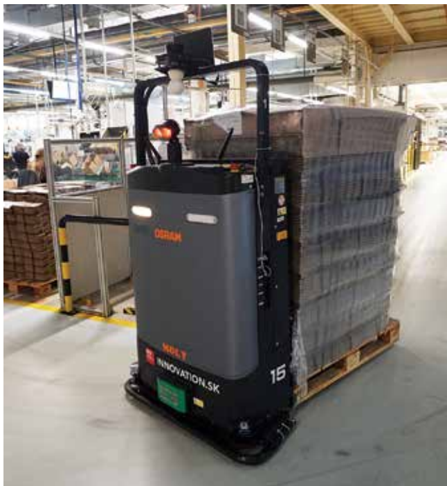
Zabalené palety sú do skladových priestorov prepravované aj pomocou autonómne navádzaných vozíkov.
